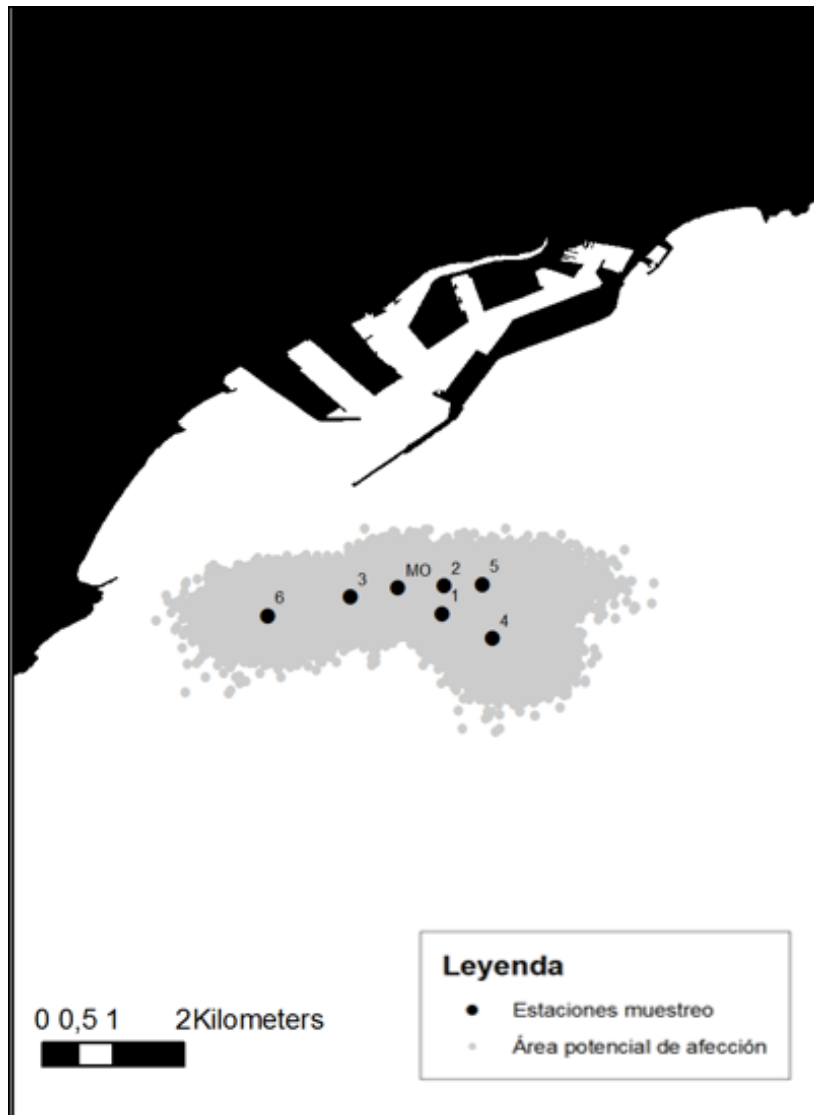
Figura 1. Diseño de la campaña realizada en el entorno de la monoboia en el puerto de Tarragona.
